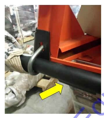
4.- FOR THE MIXERS WITH SOFT TENDERS FOLLOW THE SAME PRECEDURE AND JUST MAKE SURE THE AXLE'S PLATES ARE INSIDE THE LOOPS, BASICALLY IT IS A LIMIT GUIDE.
