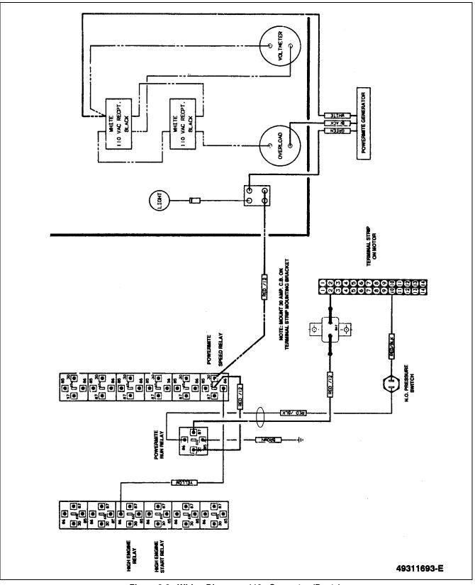
Figure 3-3. Wiring Diagram - 110v Generator (Deutz).
