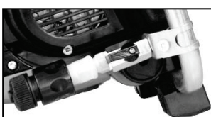
Alimentation d'eau ouverte (levier de vanne parallèle)
