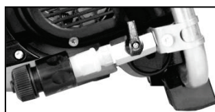
Suministro de agua cerrado (palanca de la válvula horizontal)
