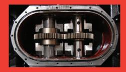
Cojinetes del vibrador de servicio pesado: aseguran larga vida útil del equipo.
