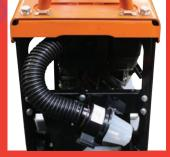
Prefiltro ciclónico: reduce notablemente la frecuencia del mantenimiento y prolonga la eficiencia máxima del motor.
