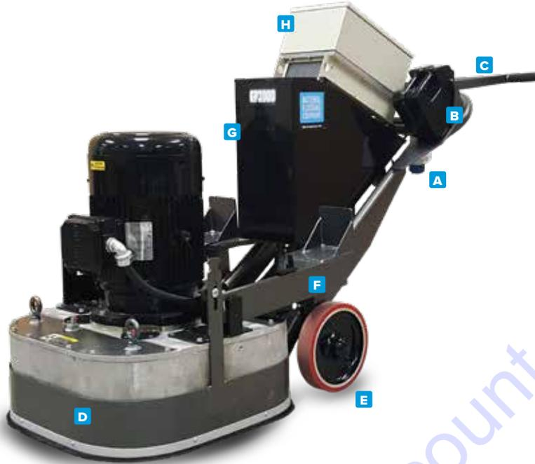
La surfaceuse et ponceuse GP3000 est idéale pour la préparation des sols en béton avant l'application d'enduits de surface, pour les chapes et le décapage, de revêtements adhésifs tout en apportant également un large choix de solutions selon outillages et puissances pour fournir un sol poli à la perfection. La largeur de travail de 711 mm et la pression augmentée de ponçage sur la tête en font la machine idéale pour les projets de sols tertiaires et industriels.
