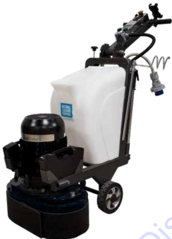
Cette meuleuse légère à contre-rotation est idéale pour les travaux domestiques et commerciaux. La GP500 offre la flexibilité d'une machine modulaire associée à la puissance de nos autres broyeurs GP.
