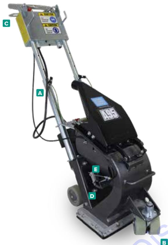
La A95 est le premier modèle de grenailleuses de sols de la série Apex de National. C'est une machine compacte, que l'on pousse, très maniable et polyvalente, idéale pour les petites et moyennes surfaces.
