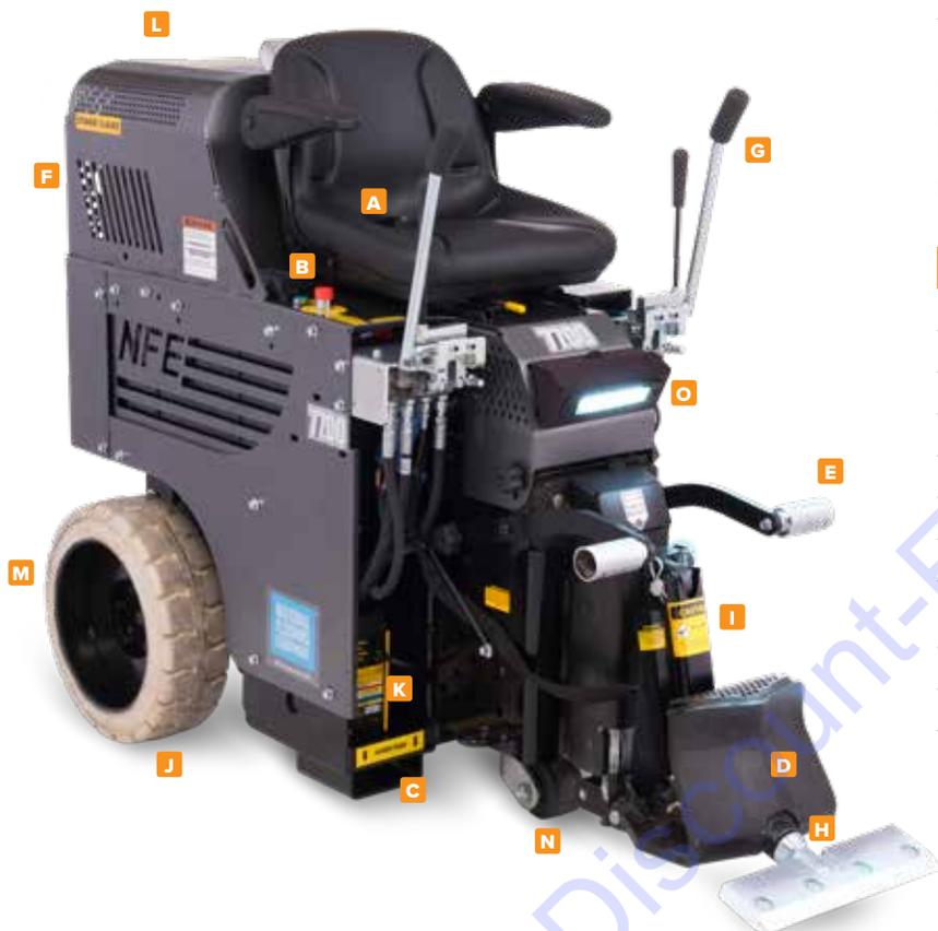
Alimentée par 12 batteries de 200AH dépassant les standards de l'industrie, cette machine est tout ce dont vous avez besoin. Plus grande, plus lourde et plus rapide que la 5700, elle est conçue pour retirer les matériaux difficiles et pour fonctionner sur la plupart des chantiers.
