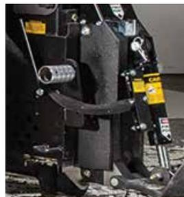
Réglez la hauteur de la plaque coulissante en utilisant la commande manuelle hydraulique afin de l'incliner avec précision. Fournie en standard **sur les** décolleuses auto-portées 7700 et 8000.
