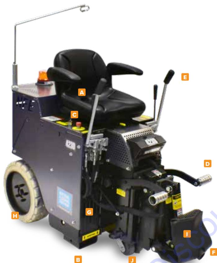
La 4230 est une décolleuse électrique autoportée, spécialement conçue pour nos clients européens. Cette décolleuse peut se vanter de faibles coûts de maintenance avec une maximisation de la production, de la manœuvrabilité et une facilité de transport sans courroies ou engrenages.
