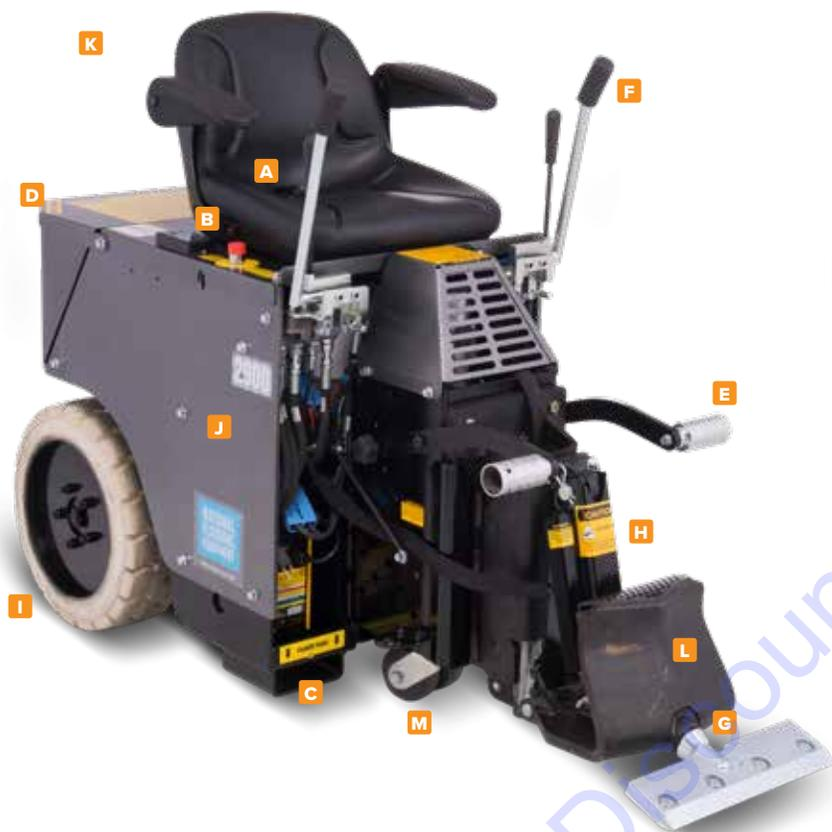
Esta máquina, diseñada específicamente para la extracción de materiales blandos a alta velocidad, es durable, libre de emisiones y económica. La 2900 extrae baldosas compuestas de vinilo y otros materiales blandos y duros de manera rápida y eficiente para aplicaciones donde el factor tiempo es crucial.
