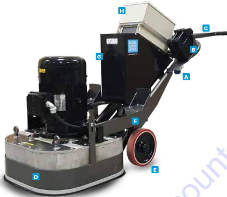
La amoladora y pulidora GP3000 es ideal para preparar superficies de hormigón para revestimientos tópicos, recubrimientos y adhesivos, al mismo tiempo que ofrece una variedad de herramientas y potencias necesarias para lograr un piso perfectamente pulido. La trayectoria de limpieza de 28 pulgadas y la mayor presión de descarga de la amoladora hacen de esta máquina la herramienta ideal para proyectos comerciales e industriales.
