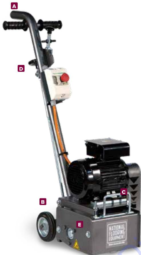
La Spartan 220 está diseñada con el marco de acero soldado más robusto de la industria y viene equipada con un sistema de tambor especial diseñado para remover puntura, revestimientos delgados, adhesivos de alfombras y otras aplicaciones finas.
