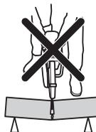
Si el disco se atasca o se engancha en el sector de riesgo de reculada, la fuerza reactiva empujará la cortadora hacia arriba y hacia atrás en dirección al usuario con un movimiento giratorio, lo que podría provocar daños graves o mortales. Preste atención al posible movimiento de la pieza de trabajo. Si la pieza de trabajo no está correctamente sujeta y se mueve durante el corte, se podría atascar el disco y provocar una violenta sacudida.
