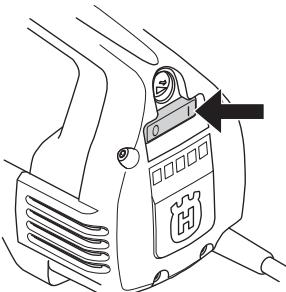
Ο διακόπτης ρεύματος χρησιμοποιείται για την εκκίνηση και το σταμάτημα του μηχανήματος.
