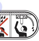
Al perforar en techo, comprobar que no puede entrar agua en la máquina. Utilice un colector de agua adecuado.
