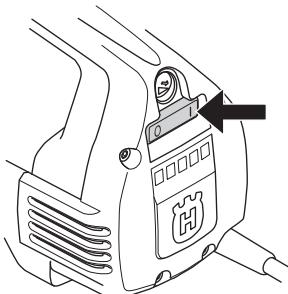
O interruptor é usado para pôr a máquina a funcionar e para desligá-la.
