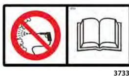
Опасная ситуация. Во избежание повреждения оборудования и нанесения травм воспрепятствовать попаданию воды в электрические и электронные детали машины! Читать руководство по эксплуатации!
