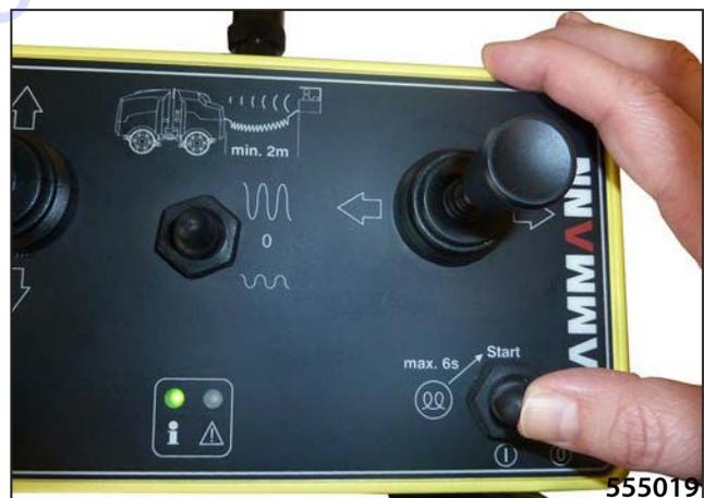
Bei Verwendung des Zusatzstartaggregats muss die Startspannung 12 V betragen.
