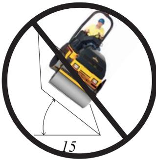
Nunca hacer funcionar la máquina más allá del ángulo de vuelco. Consultar la sección Datos técnicos para el ángulo de vuelco y la pendiente máxima. El funcionamiento de la máquina más allá del ángulo de vuelco causará inestabilidad de la máquina. Esto podría causar lesiones al operador o daños al motor o la máquina.
