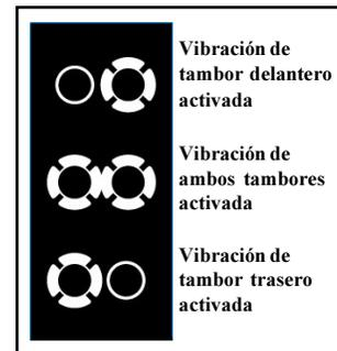
Posiciones del interruptor de vibración
