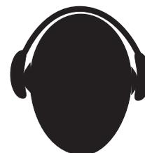
Dado que con esta máquina se puede sobrepasar el nivel de ruido nominal permitido de 89 dB(A), el operador debe usar protección adecuada de los oídos.
