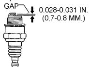
Figure 19. Spark Plug Gap
