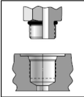
Figure 5-8. ORB-MPP Thread
